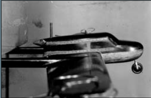
WINDTUNNELMODEL VAN DE FOKKER F.25 PROMOTOR
