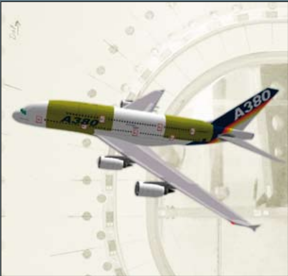
GEbruik VAN GLARE (Groen) OP DELEN VAN DE AIRBUS A380
