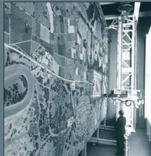
MAQUETTE WAAROVER EEN CAMERA BEWEEGT OM UITZICHT TE GENEREREN VOOR DE VLEGER
