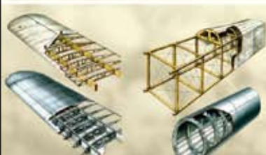
Verandering van vleugelconstructies (van hout en linnen tot metaal)
