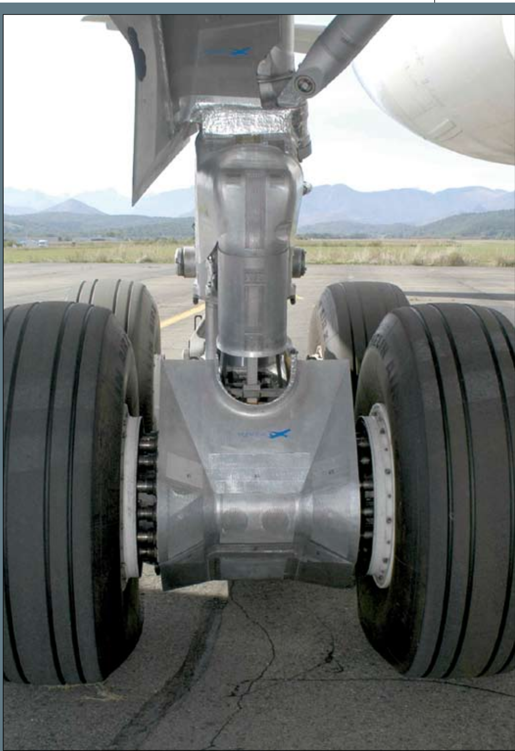
STROOMLIJN VAN Vliegtuigonderstellen vermindert de geluidsproductie.
