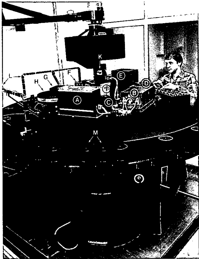
Fig. 12 — Het standregelmodel op de luchtgelagerde simulatietafel. The attitude control model on the air-bearing simulation table.
