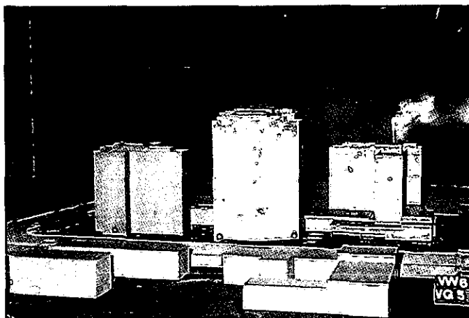
Bepaling van het windklimaat, de winddrukken en de rookverspreiding rond het Wereldhandelscentrum te Amsterdam aan een model van dit gebouwencomplex in de lage-snelheidswindtunnel. Determination of wind effects, wind pressures and smoke dispersion around a high-rise complex in the low-speed wind tunnel.
