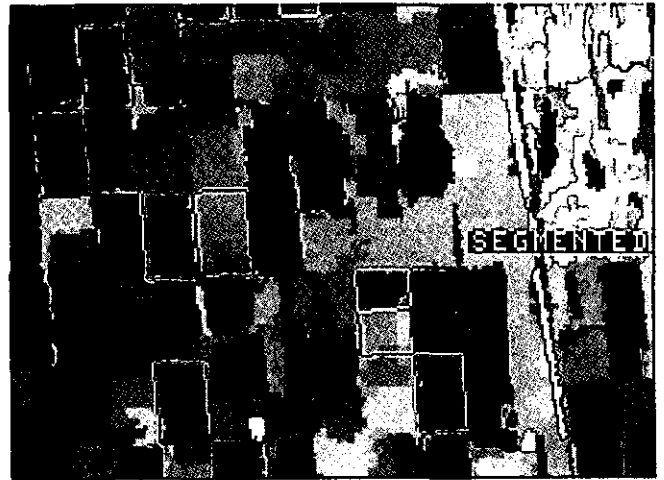
Gesimuleerde multitemporale SAR beelden van een landbouwgebied, vóór (links) en na (rechts) segmentatie. De kleuren worden bepaald door de gewassoorten; de akkers zijn ongeveer 10 ha groot.
