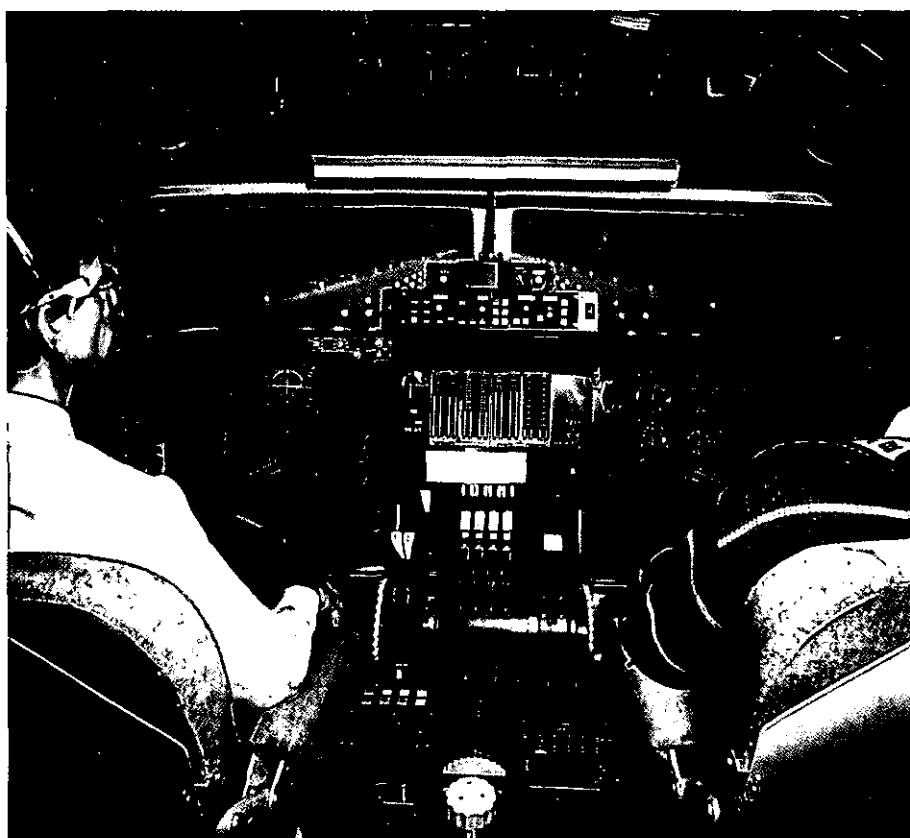
De vluchtnabootser van het NLR met EFIS primary flight display en navigatiedisplay.
