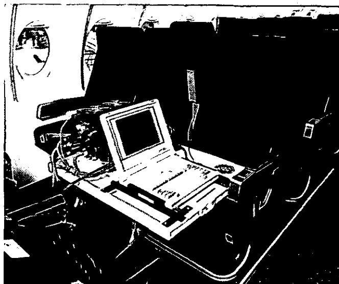
Het door het NLR ontwikkelde Production Test Flight (PTF) systeem bestaat uit een data-acquisitie-module (links) en een dataverwerkingsmodule (rechts). Beide modules worden op eenvoudige wijze aan de stoelen van de Fokker 100 of Fokker 50 vastgesnoerd. Het PTF-systeem kan worden aangesloten op de boordapparatuur zonder modificaties, en levert direct na de proefvlucht de verwerkte meetgegevens.
