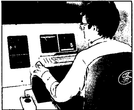
De plaats van de co-piloot van de Hermès, die de robotarm bedient, in het Flight Teleoperation Test Bed, onderdeel van de Hera simulatiefaciliteit HSFP.
