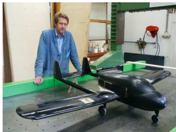
Het F.25 windtunnelmodel, onlangs gerestaureerd door de heer L. Tillemans (houtbewerking in de NOP)
