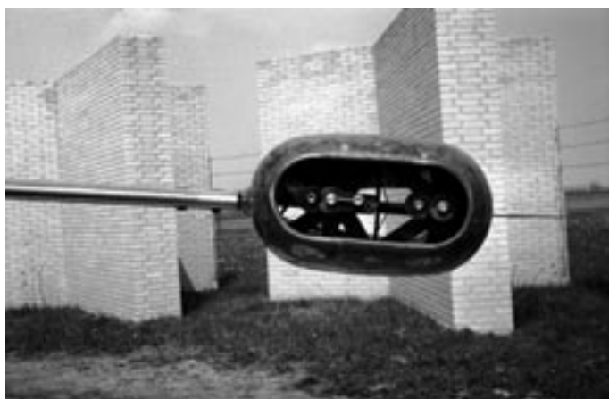
Opnamen van de rotorproefdraaiplaats in de Noordoostpolder waarin een rotorblad en ramjetmotor worden beproefd voor de Kolibrie helicopter. Bron: M. Reitsma, voormalig NLL-medewerker in de NOP
