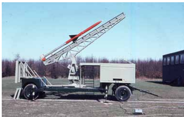
Lanceerwagen met daarop een model, gekoppeld aan een lichte aandrijfkraket. Deze foto is genomen achter het tegenwoordige R-gebouw
