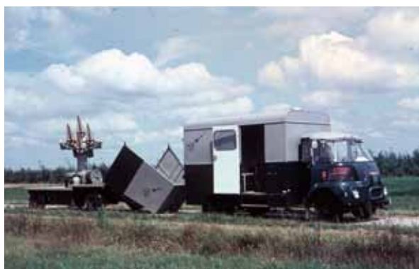
Bedieningswagen en antennewagen van het automatisch volgsysteem (jaren '60)
