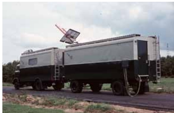
Commandoauto met voorop net zichtbaar de antenne van de rondzoekradar. Meetvoertuig als aanhanger van de commandowagen, met voorop de omhoogstekende antennes voor ontvangst van de telemetrie- en dopplersignalen. D
