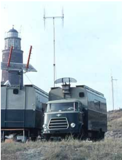
Commandowagen en meetwagen, opgesteld op het platform vlak bij de vuurtoren van Texel. Opgerichte antennes van telemetrie en doppler. Daarboven uitstekend de antenne voor de communicatie met de waarnemers op het Texelse wad, waar het model na de vlucht met een parachute landt. Het kenteken VB-35-95 is bij het RDW in 1963 geregistreerd als 'bedrijfswagen, geschikt voor aanhanger/oplegger'
