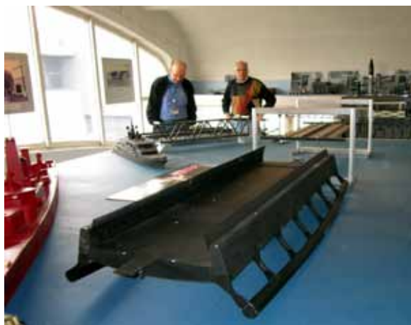
Windtunnelmodel van de Westergobrug in Zoetermeer
