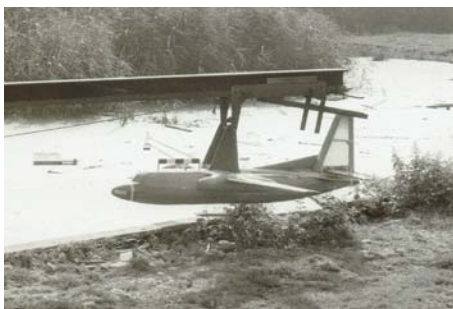
Figuur 9 Het ditchmodel op de lanceerinstallatie aan de Westlandgracht. Met een valgewicht werd het model gelanceerd.
