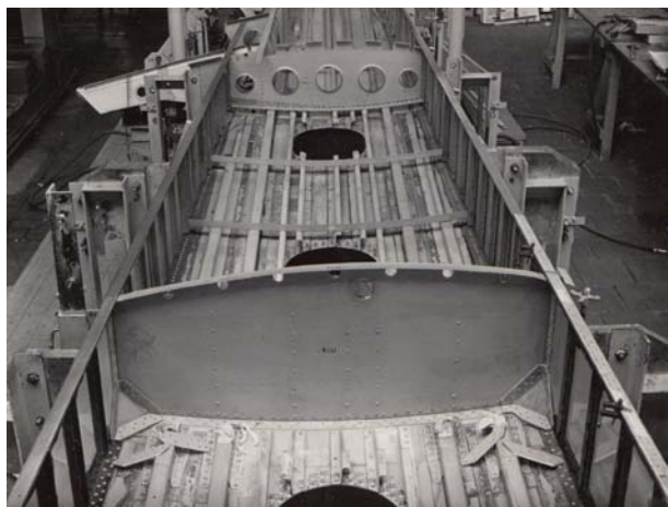
Figuur 3 De vleugelconstructie van de F27. Links en rechts de twee liggers. Twee ribben en delen van drie elliptische uitsnijdingen in de trekhuide van de vleugel zijn zichtbaar.
