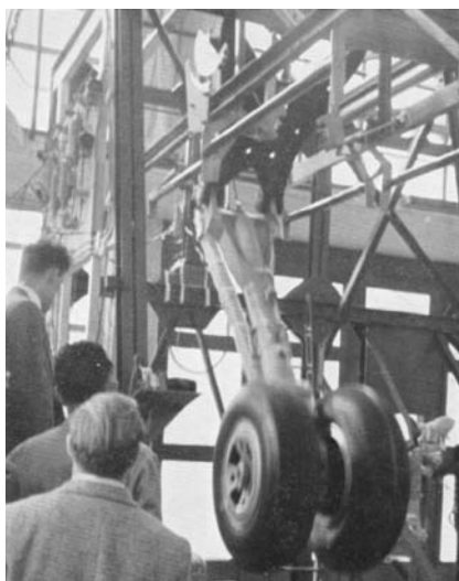
Duurproef op het landingsgestel van de F27 Friendship. Bron: NLL-jaarverslag 1957
