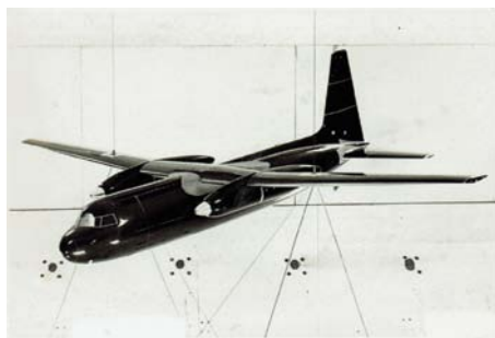
Figuur 3 Een vroege versie (1953) van het 3-D (schaal 1:15) model in de tunnel. Dit model is kort, had nog een 'oude' rompneus en een afwijkende staart.
