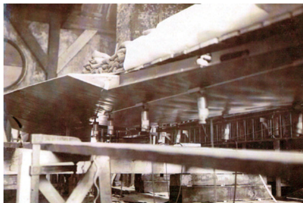
Figuur 5 Plooivorming bij proef B, n=4.
