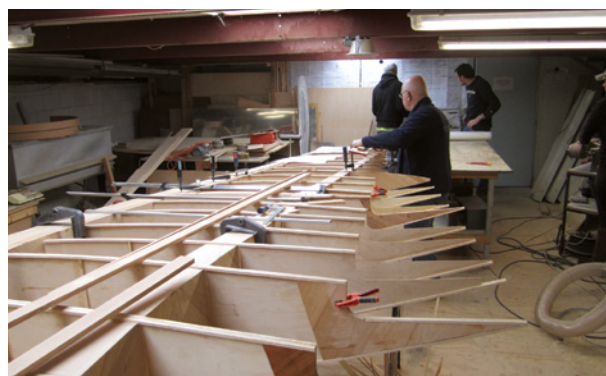
Figuur 4 D-XXI replicavleugel in aanbouw.
