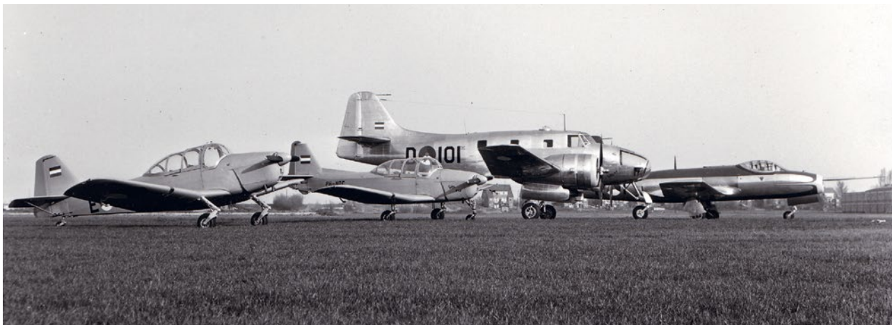
V.l.n.r.: De door Fokker gebouwde S.11, S.12, S.13 en S.14 Machtrainer
