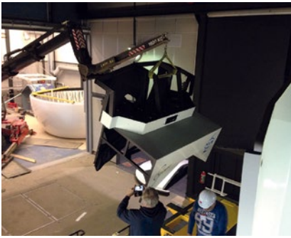
Het bovenstuk, waar de projectoren in gemonteerd zitten, wordt weg-getakeld.
