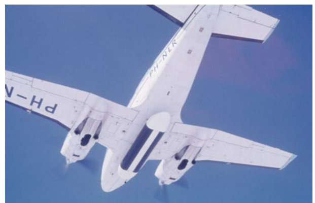
Beechcraft QueenAir met SLAR antenne onder de romp.
