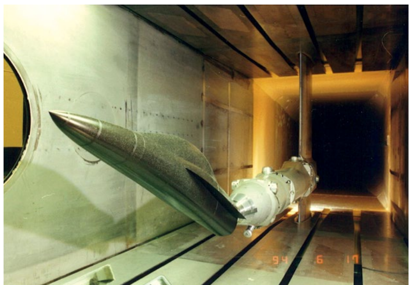
Windtunnelmodel in de HST voor het meten van de wervelstroming rond het rompvorstuk van een gevechtsvliegtuig bij grote invalshoek.
