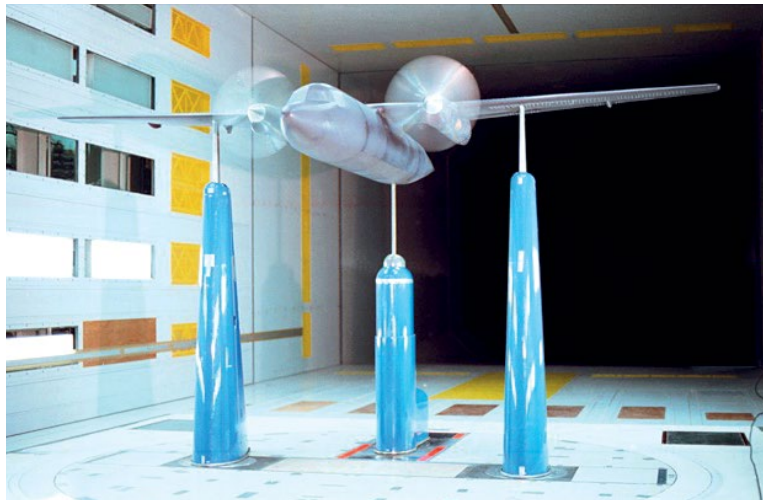
De opstelling van het Fokker F.11 windtunnelmodel
