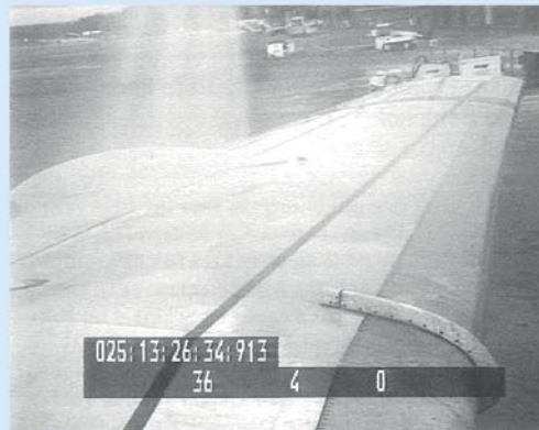
Videobeeld van de vleugel van het Fokker 70 prototype, genomen met het NLR-videosysteem op 30-11-1994 in Gardemund (Noorwegen) tijdens onderzoek naar de effectiviteit van ontijzingsvloeistof. Eerst laat men ijs aangroeien, waarna de vleugel met ontijzingsvloeistof wordt bespoten. Na een bepaalde wachttijd (onder andere afhankelijk van de soort vloeistof en de verdunning) gaat men taxiën, waarbij het ijs moet loslaten
