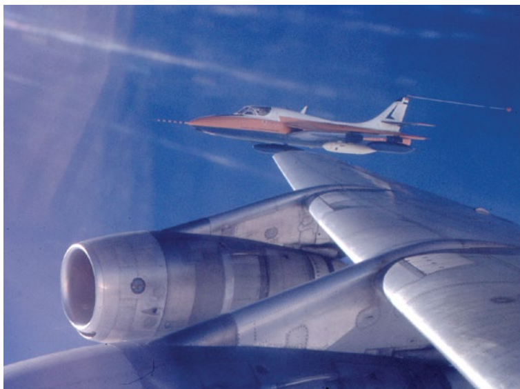
Het Hunter laboratoriumvliegtuig in de configuratie voor het uitvoeren van meetvluchten voor het ijken van de snelheidsmeter van een Douglas DC 8-55 (zie voorgrond). Deze vluchten werden uitgevoerd in opdracht van de KLM in het kader van een onderzoek naar het brandstofverbruik. De gesleepte statische buis met kegel aan het verticale staartvlak wordt gebruikt voor het nauwkeurig meten van de statische druk.
