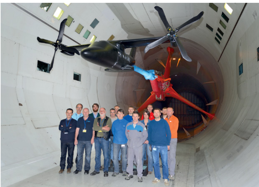
Testen van het NICETRIP model in de ONERA-S1 windtunnel in Modane
