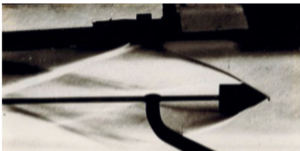
Fig. 2: Kegelmodel bij Ma=6 in de 3 \times 3 \text{ cm}^2 supersonische tunnel (1951)
