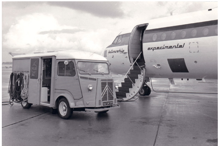
De Citroën testwagen, met uitleesapparatuur voor de magneetbanden en ook de directe elektrische signalen van de DR28. De testwagen had ook een eigen omvormer, waarmee de instrumentatie, buiten de boordvoeding om, van spanning kon worden voorzien.
