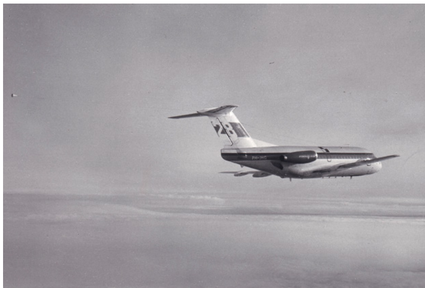
F28 prototype A1 met gesleepte kegel.
