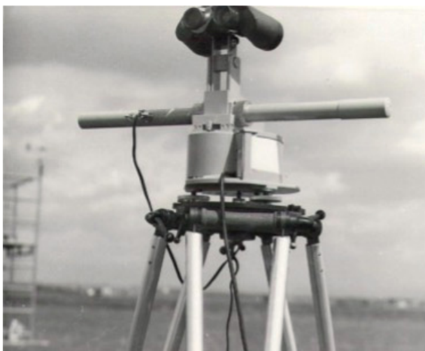
Quick Look apparaat, waarmee het startende of landende vliegtuig door een bedienaar (meestal Gerard van Wely) werd gevolgd in azimuth en elevatie. Deze bewegingen werden overgebracht op een kraspen die op een strook waspapier de vliegtuigbaan vastlegde. Links op de achtergrond de Meteopost.
