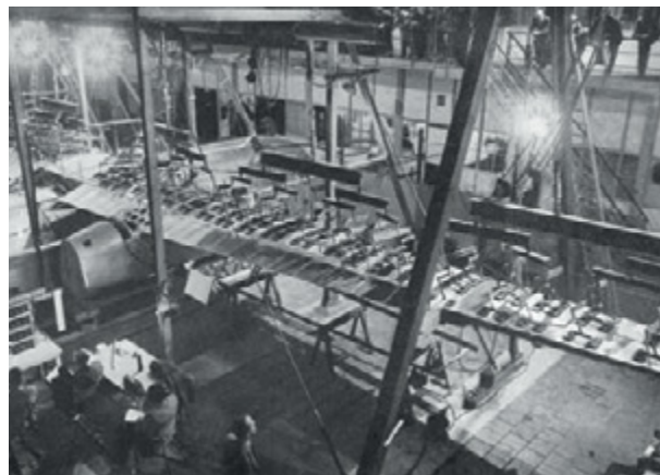
Figuur 11. Belastingproef op de vleugel van de F27 Friendship. (bron: NLL-jaarverslag 1956)
