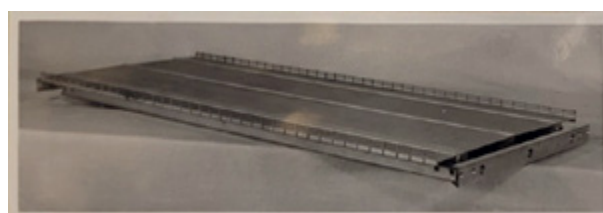
Fig. 1 Windtunnel model van een sectie van de Van Brieneoordbrug
