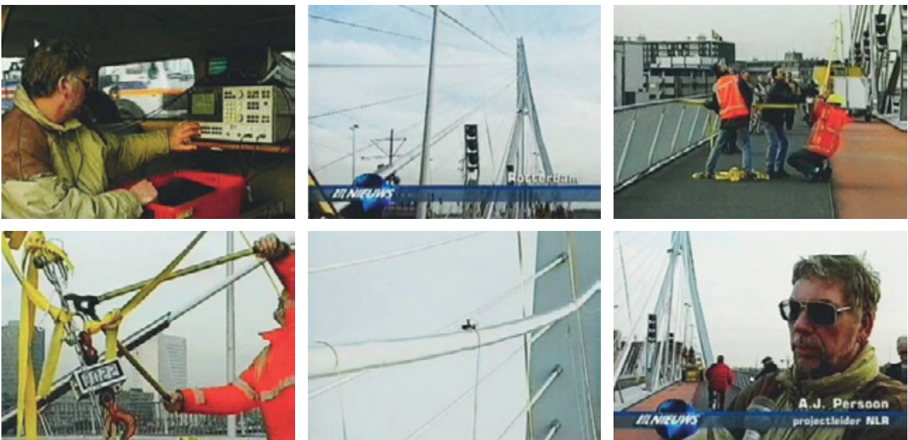
Fig. 9 Meting van de trillingsfrequentie van een tui van de Erasmusbrug
