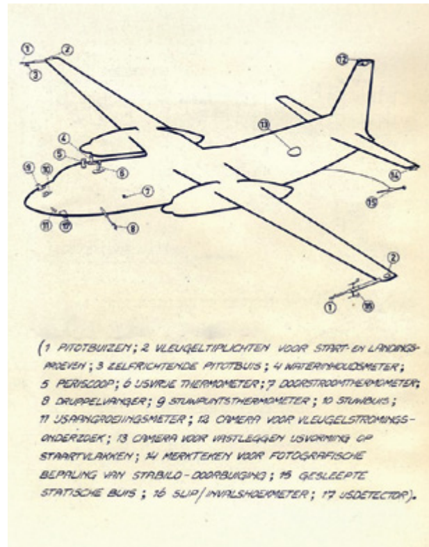
Figuur 14. Overzicht van uitwendig geplaatste meetapparatuur op de F27.
